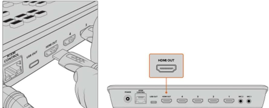
Pasang HDMI tv atau menotir ke Output HDMI ATEM Mini, anda dapat menggunakan program monitor output dan mengecek seluruh sumber bekerja dengan baik
