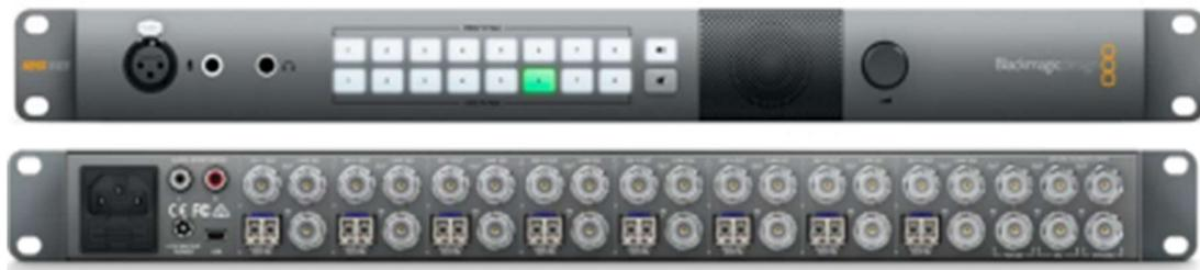
ATEM Talkback Converter 4K digunakan untuk menghubungkan hingga 8 kamera ke switcher melalui kabel coaxial hingga 12G-SDI. Saat terhubung ke ATEM Switcher, anda juga mendapatkan tally, ditambah anda juga dapat terhubung ke ATEM Camera Converter melalui serat optik untuk menambahkan talkback. Blackmagic Studio Camera terhubung ke ATEM Talkback Converter 4K melalui BNC atau modul serat optik opsional. Anda juga mendapatkan talkback dan tally saat terhubung ke ATEM Switcher.
