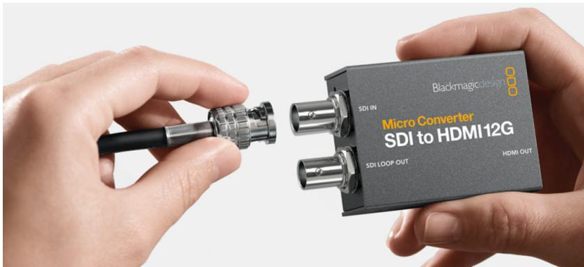
Hubungkan sumber video SDI ke SDI input Micro Converter SDI to HDMI atau Hubungkan sumber video HDMI ke HDMI input Micro Converter HDMI to SDI
